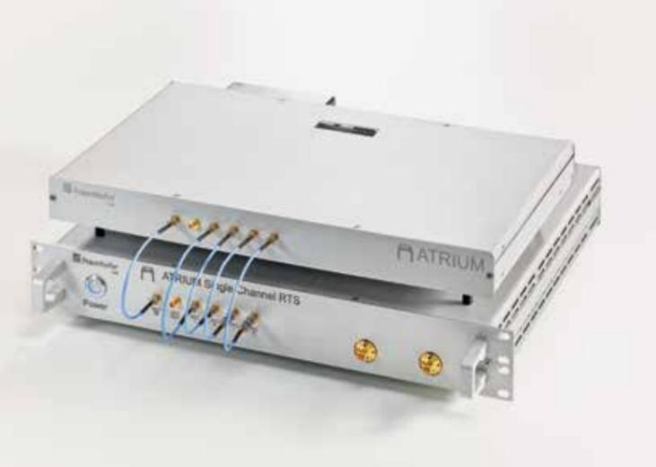
Einkanaliger Radarzielsimulator (oben) und künstlerische Darstellung des im Aufbau befindlichen mehrkanaligen Radarzielsimulators (unten).
